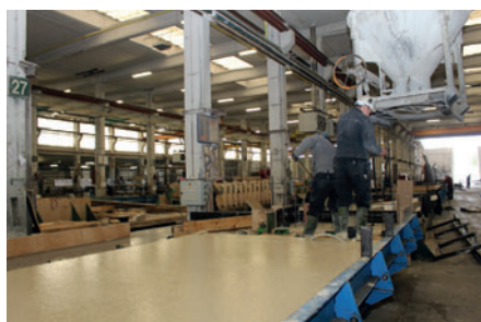
Производственный цех с новыми кантовательными стендами Construx
