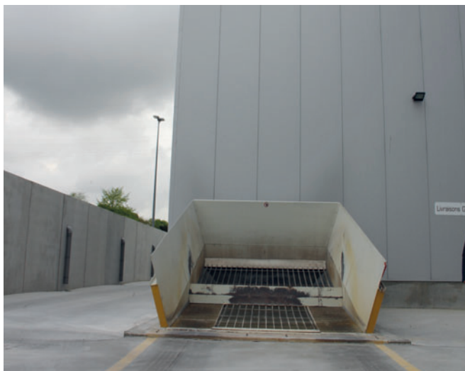
Загрузка бункеров для заполнителей осуществляется через приемную воронку для грузовиков
