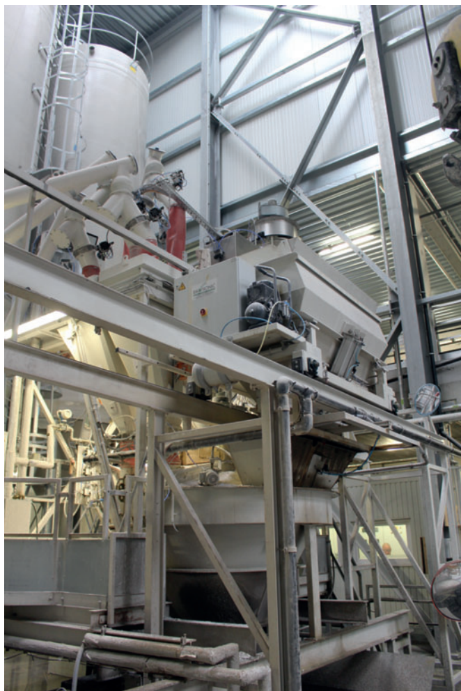
Весы передвигаются непосредственно к смесителю и выгружают в него материал
